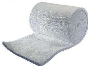
As mantas de fibra cerâmica são produzidas a partir da eletro fusão da sílica e alumina, pelo processo Spun, obtendo-se fibras longas. Essas fibras são multidirecionadas, adensadas e entrelaçadas num processo contínuo de agulhamento, conferindo ao produto excelente resistência mecânica. As mantas possuem alta refratariedade, excelente resistência ao manuseio e a corrosão.
