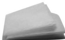
Véu de vidro ISOLATI é um véu de superfície feito com um vidro resistente a qualquer ataque químico, o que permite a durabilidade e longevidade de uma peça, dando-lhe resistência contra soluções alcalinas e ácidas. Os filamentos de vidro usados na fabricação deste véu são tratados com resinas sintéticas formuladas para dar compatibilidade tanto com resinas poliéster como epóxi. É usado para diversas aplicações como reforço e em laminados que devem ter pequena espessura e/ou bom acabamento.
